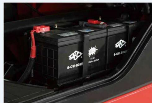
La batteria si trova sopra il serbatoio del carburante, con un cassone e una piastra adiabatica tra di esse per prolungare la durata della batteria.
