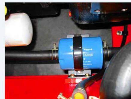
Aggiungere il filtro di ritorno dell'olio del cambio e della multivalvola, per migliorare la pulizia della trasmissione e dell'olio idraulico.
