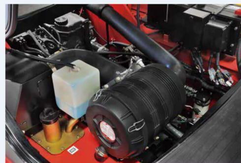
Il nuovo filtro dell'aria stampato con aspirazione tangenziale, doppia guarnizione e filtro di sicurezza è durevole, non soggetto a corrosione e resistente alle vibrazioni, e garantisce una migliore efficienza del filtro e una minore resistenza all'aspirazione rispetto al precedente.
