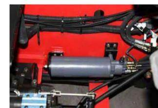
L'impianto frenante è dotato di un sistema di accumulo di energia che, quando il motore viene spento, è in grado di fornire più di 4 volte una frenata di emergenza.
