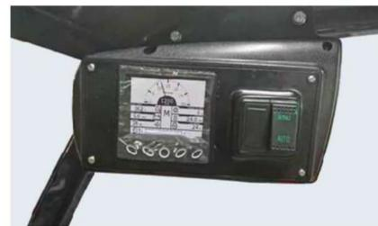
Strumento interattivo: lo strumento adotta un display LCD con quattro pulsanti interattivi e dispone di una funzione di comunicazione CAN bus. Il protocollo di comunicazione è compatibile con gli standard CANopen e SAE J1939.
