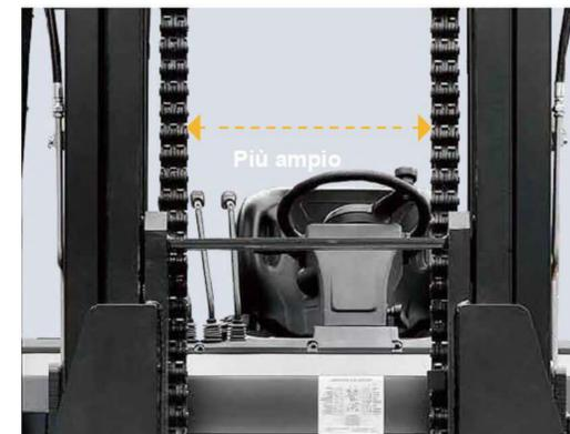
Il montante di nuova concezione offre un'ampia visibilità in avanti grazie alla posizione esterna dei tubi idraulici del posizionatore forche.
