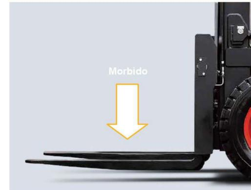
Oltre al sistema di atterraggio morbido, viene adottato il sistema di sollevamento morbido (cilindri di sollevamento anteriori del montante triplex e del montante duplex completamente libero), che consente di ridurre notevolmente il rumore e gli urti del montante.
