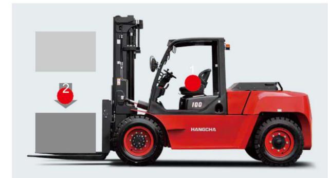
1. Il sistema di sensori del sedile incorpora la funzione di sollevamento/inclinazione e di blocco della corsa. Quando l'operatore lascia il sedile, il sistema blocca automaticamente il sollevamento/inclinazione e disattiva la marcia per garantire la sicurezza.
